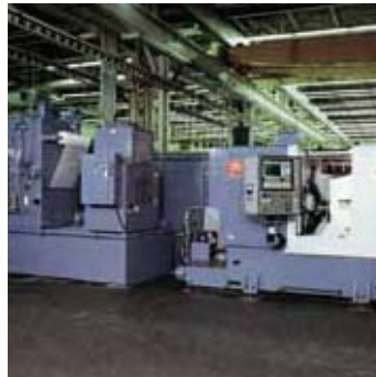
グリーソン傘歯研盤フェニックス #400PG Gleason PHOENIX Bevel Gear Grinder #400PG
