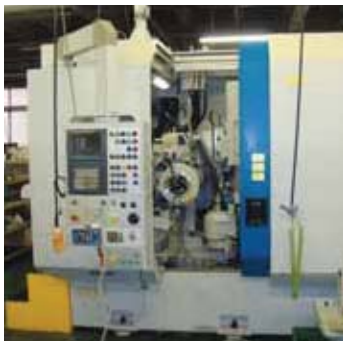
平歯研盤 400GX(グリーソンオカモト) Gleason OKAMOTO Cylindrical Gear Grinder 400GX
