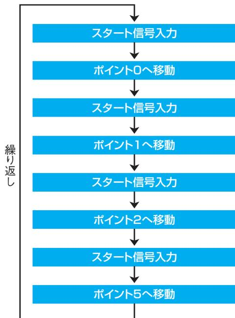
※各ポイントへ移動完了時 INPOSI信号が出力されます。
