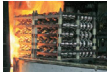
熱処理 (ガス浸炭焼の装置)
