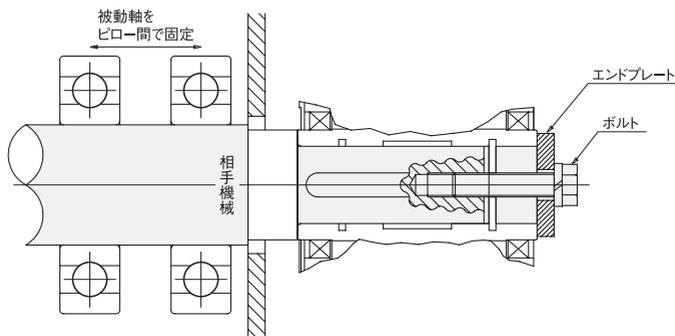
図-3 エンドプレートによる固定
